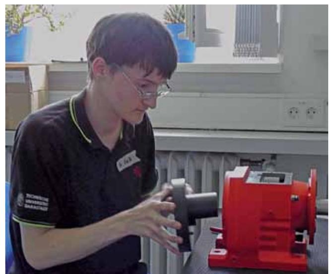
Abb. 2: Montage des Demogetriebes
